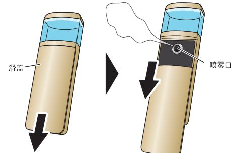
轻轻向下滑动滑盖，纳米离子会自动生成水雾从喷雾口中喷射而出。
